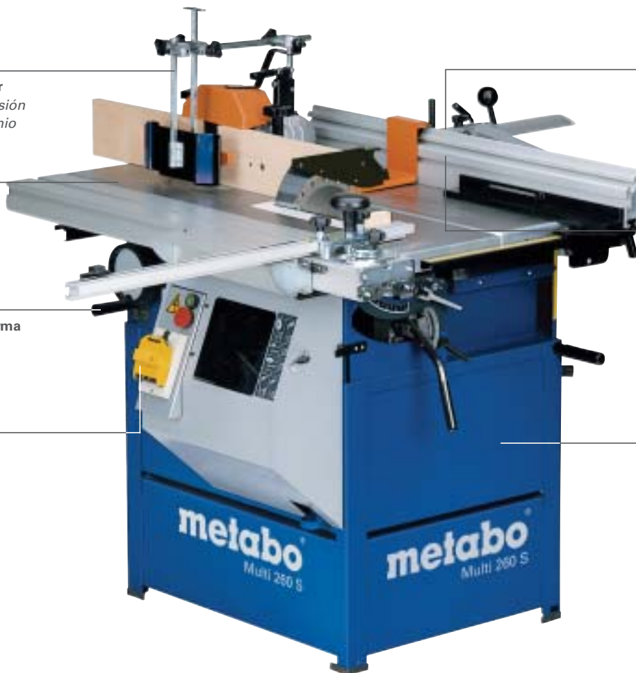
Multi 260 S como sierra circular de mesa con hoja de sierra de metal duro y carro de rebordeado de serie.
